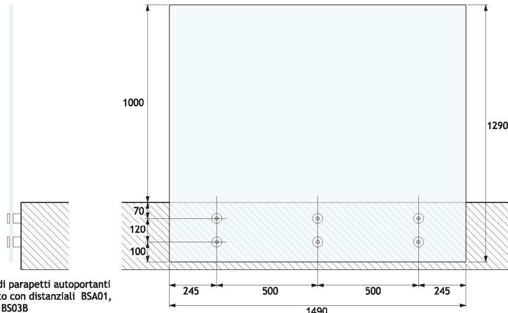
Schema per la realizzazione di parapetti autoportanti in vetro temperato stratificato con distanziatori BSA01, BSA01B, BS01, BS01B, BS03 e BS03B
